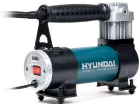
Профессиональный компрессор с прямым приводом, мощный электродвигатель приводит в движение цилиндропоршневую группу на основе прямого привода, за счет чего достигается высокая производительность. Алюминиевые ребра охлаждения увеличивают время непрерывной работы компрессора. Разработан для подкачки шин легковых автомобилей, квадроциклов, мотоциклов, велосипедов и надувной продукции для активного отдыха.
