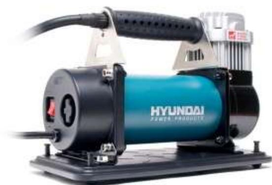
Профессиональный компрессор с прямым приводом, мощный электродвигатель приводит в движение цилиндропоршневую группу на основе прямого привода, за счет чего достигается высокая производительность. Алюминиевые ребра охлаждения увеличивают время непрерывной работы компрессора. Разработан для подкачки шин легковых автомобилей, внедорожников, коммерческого транспорта, квадроциклов, мотоциклов, надувных матрасов и т.п.
